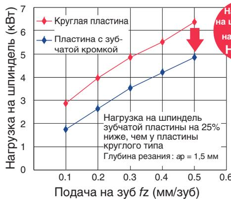
Нагрузка на шпиндель на 25% НИЖЕ
