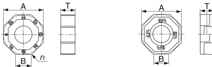
MJ, ML (16 режущих кромок) W (Wiper (зачистная пластина) 8 режущих кромок)
